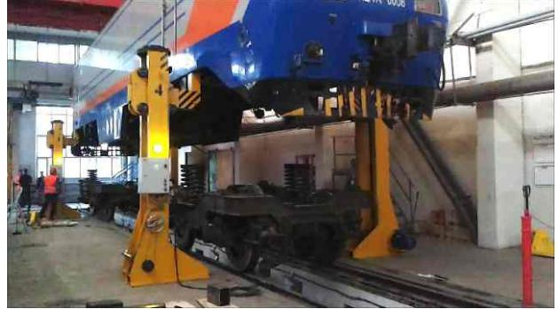
Домкратные установки применяются для подъема и удержания всех типов вагонов, полуваагонов, локомотивов и т.д. в верхней позиции для получения доступа к демонтажу оборудования в подрамной зоне.
